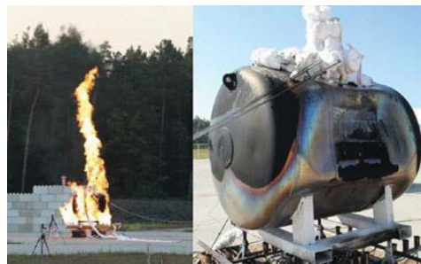
Fig. 5. BLEVE test (Anders Ødegård et al., 2022)
